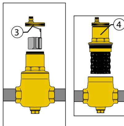
La particolare costruzione del separatore di microbolle permette di effettuare operazioni di manutenzione e di pulizia senza dover rimuovere il dispositivo dall'impianto, in particolare:
